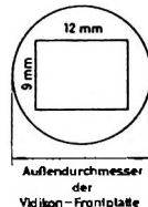
Bild 10. Abmessungen der Maske zur Erzeugung der Schwarzscher
